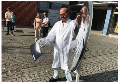
Rajinder Singh beweist: Solarkocher sind nicht nur was für Afrika und die Tropen. Sogar in unseren nördlichen Breitengraden kann ein einfacher Parabolspiegel in wenigen Sekunden Temperaturen von bis zu 700 Grad erzeugen.
